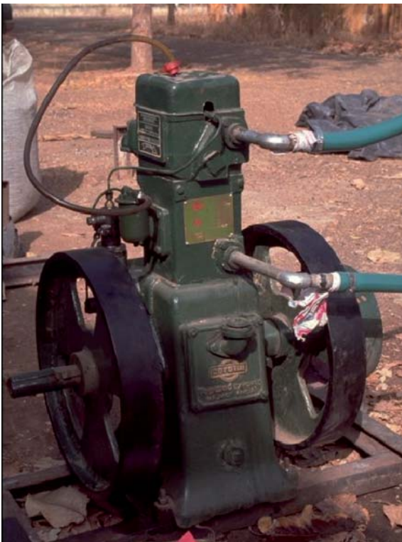
Moteur indien fonctionnant à l'huile de pourghère. Centre National de l'Energie Solaire et des Energies Renouvelables (C.N.E.S.O.L.E.R) - Mali
